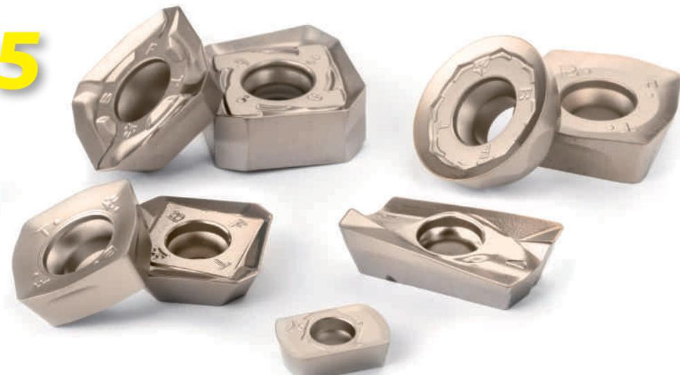
**CCT35** è la nuova qualità per acciai inossidabili ed acciai inossidabili resistenti al calore quali duplex e super duplex. Grazie all'innovativo substrato capace di resistere al calore che si genera durante l'azione di taglio ed al basso coefficiente di conduttività termica, è possibile fresare con velocità di taglio che variano a seconda delle condizioni di lavoro, **dai 100 m/min fino ai 250m/min**. Lavorazione da eseguire rigorosamente a secco.
