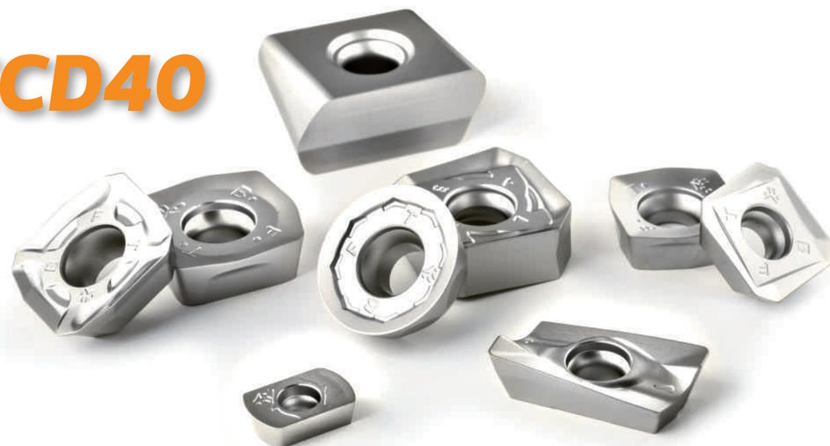
**CCD40** è l'innovativa qualità per la fresatura di titanio, leghe di titanio e superleghe resistenti al calore (HRSA), quali inconel, hastelloy, stellite, haynes. L'estrema durezza di questo grado di metallo duro, HV 4500, e la sua buona tenacità ne riducono l'usura per abrasione. La fresatura di questi materiali va eseguita rigorosamente ad umido per evitare il fenomeno del tagliante di riporto, con emulsione al 10-12%. La velocità di taglio varia dai **40m/min ai 70m/min**.
